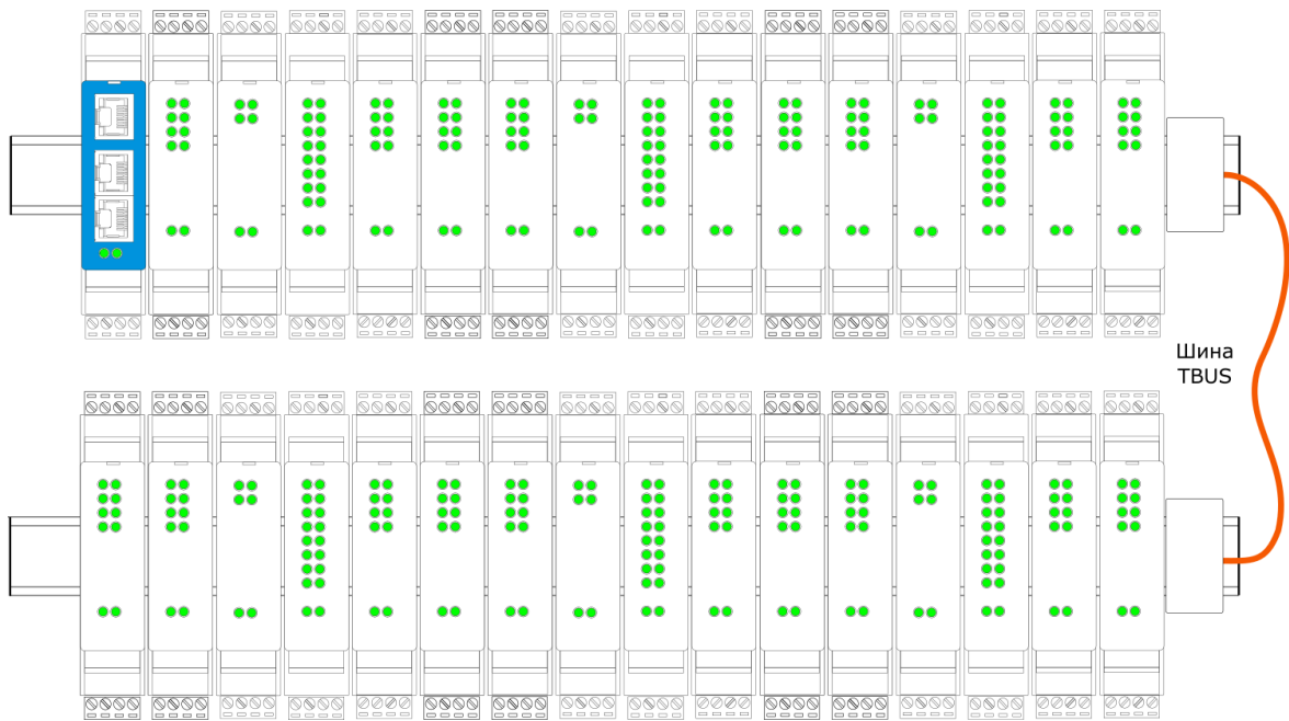
Рисунок 2 - Контроллер ERGON в шкафу автоматизации
