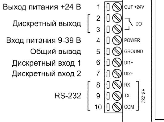
Рисунок 1 – Схема подключения и распиновка контактов УПВН-1
