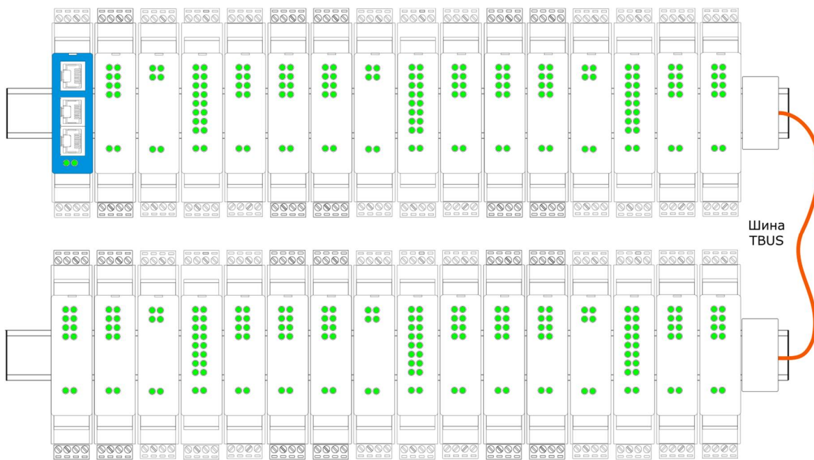
Рисунок 2 - Контроллер ERGON в шкафу автоматизации
